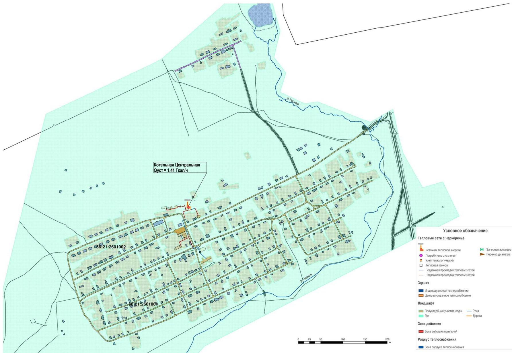
Рисунок О1.1. Принципиальная схема места расположения источника тепловой энергии Котельная Центральная
